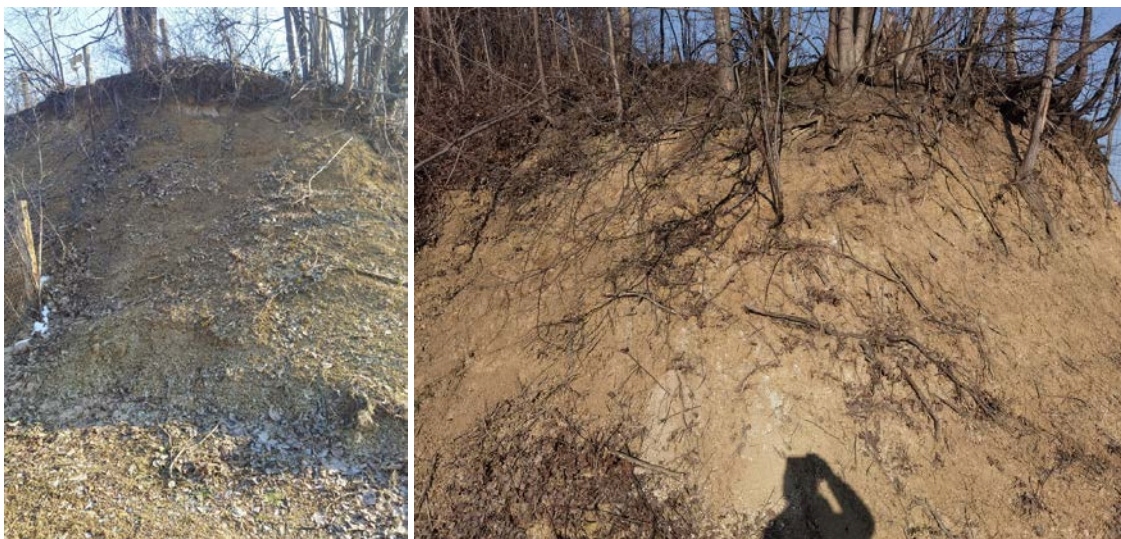
Слике 14. и 15. Карактеристичан профил коре површинског распадања основних миоценских лапораца и лапора
